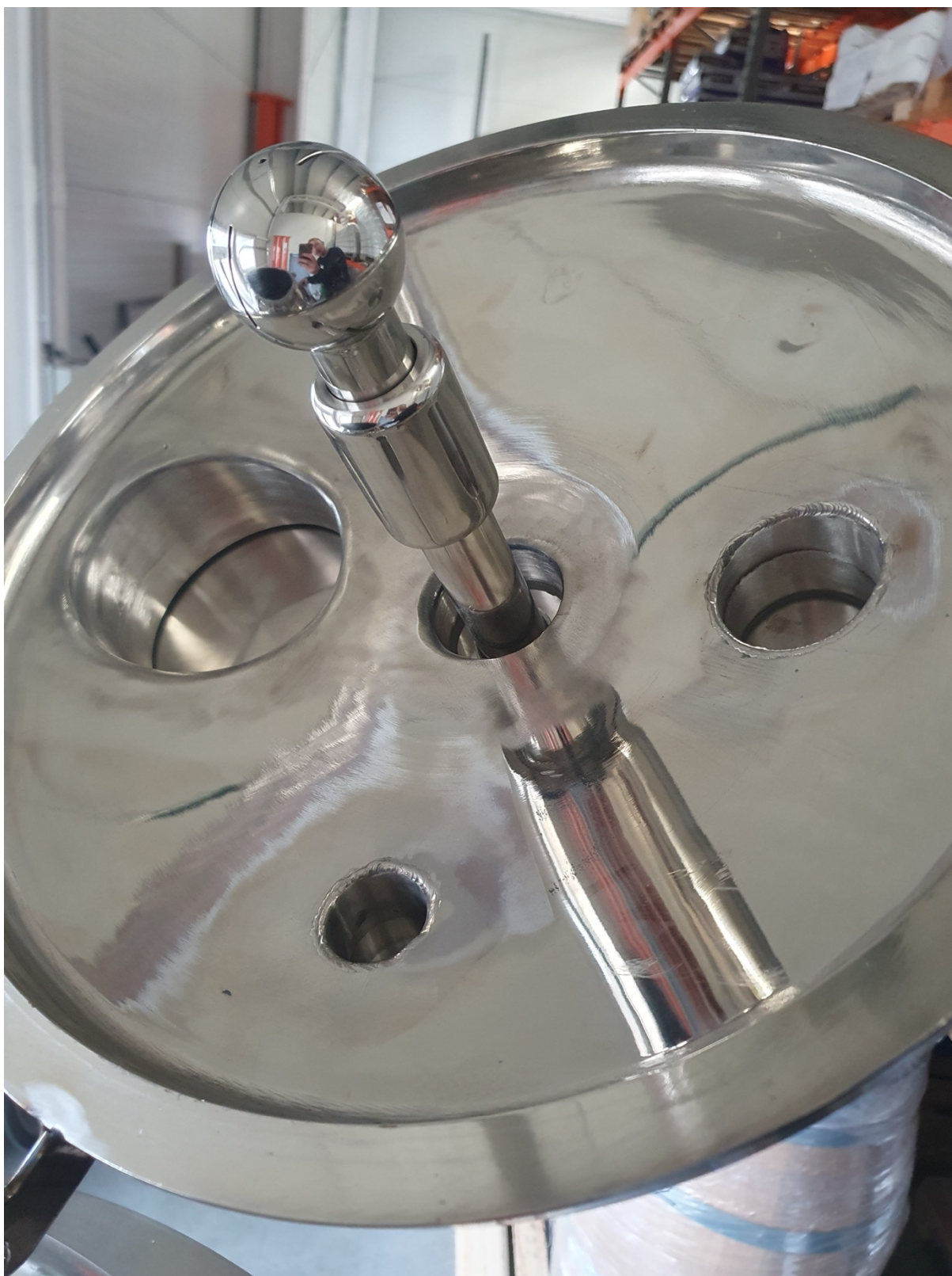
Detail vrchního klobouku s CIP hlaví, která je připravena na prodlouženém potrubí.
