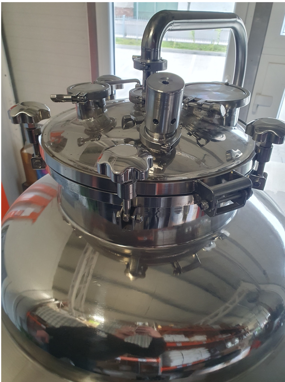
Detail vrchního klobouku CK tanku.
